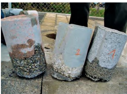
Bild 7: Bohrkernentnahme für Vergleichsprüfungen unterschiedlicher Mörtelsysteme für die gebundene Bauweise
